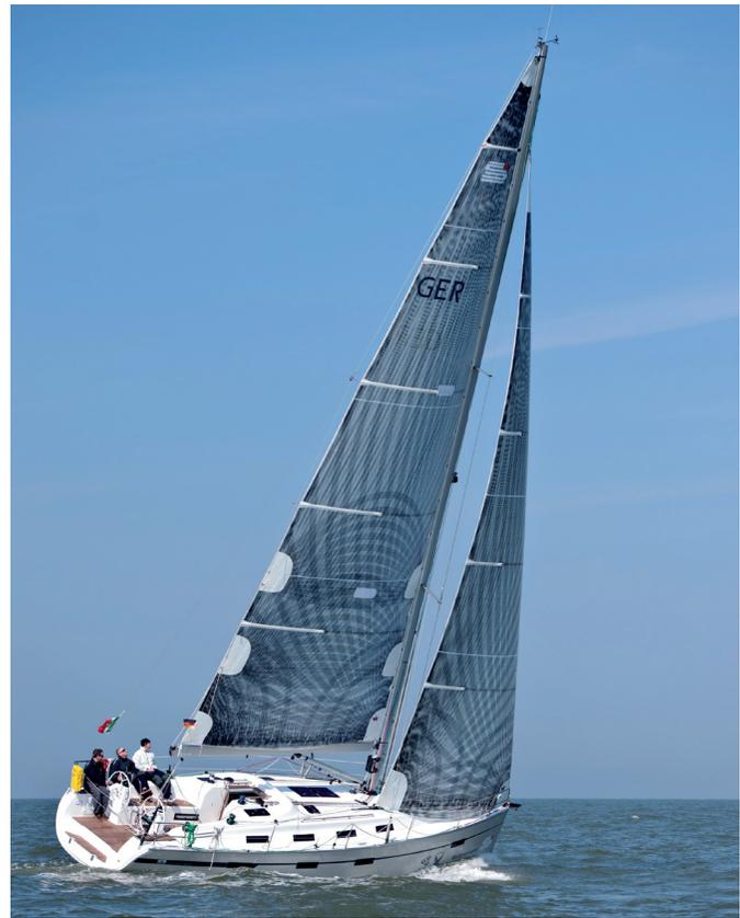
des Drucks auf 0,9 bar verlaminiert, wobei durch die Perforation Luft und Lösungsmittel (beschleunigt den Aushärtungsprozess) entweichen. Das Herstellungsverfahren der Membrane ist weltweit einzigartig, da die Segelmembrane mittels Vakuum während des ganzen
