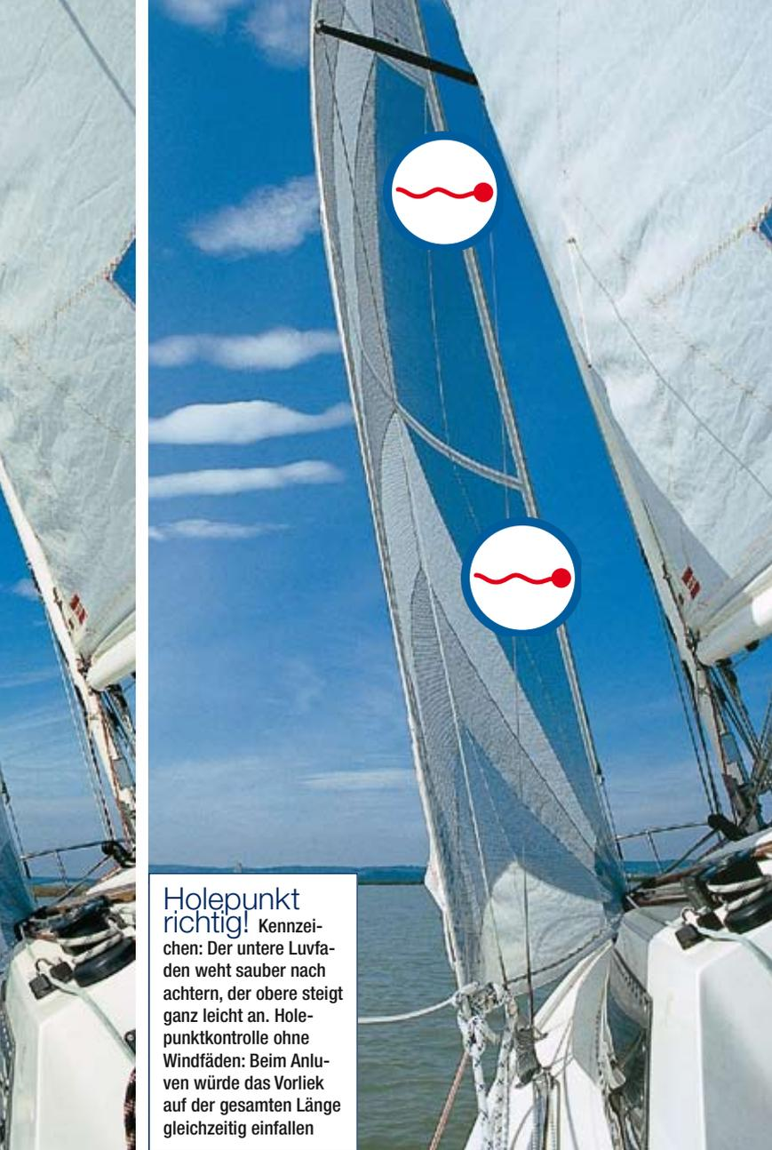
**Holepunkt richtig!** Kennzeichen: Der untere Luvfaden weht sauber nach achtern, der obere steigt ganz leicht an. Holepunktkontrolle ohne Windfäden: Beim Anluven würde das Vorliek auf der gesamten Länge gleichzeitig einfallen
